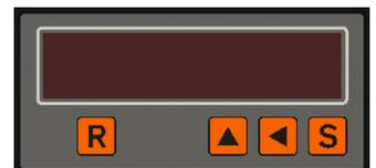
Mediante **S**, **▲** y **◀** se pueden editar los valores modificables (reloj, alarmas y configuración). Primero hay que entrar en edición, lo que en cada caso se hace de una forma distinta según se explica mas adelante. Una vez en edición, la función de las teclas o sus entradas externas equivalentes es la siguiente:
