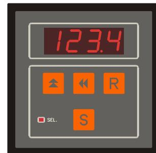
Si el tacómetro está configurado con  $5.n 5= 1$  (tiene selección) y  $7.d E= E d$ , (edición permitida), se permite la edición de la selección. Esta se edita mediante las teclas **S**, ▲ y ◀ del siguiente modo:
